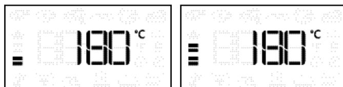
Une flèche clignotante en boucle à côté de la température cible indique la phase de préchauffage. Lorsque le four atteint la température cible, un signal sonore retentit.
