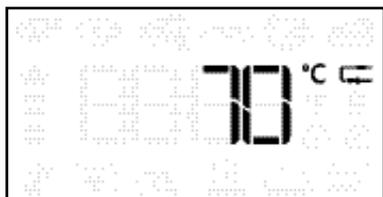
Si le thermomètre à viande est inséré pendant la sélection d'une fonction, l'écran passe à la température cible par défaut du thermomètre à viande.
