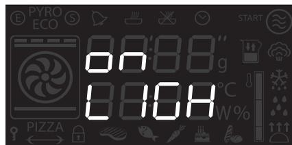
Pour empêcher l'appareil d'éteindre la lampe automatiquement au bout d'une minute, sélectionnez ce mode sur OFF.
