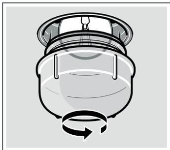
3. Remplacez l'ampoule par un modèle similaire.
