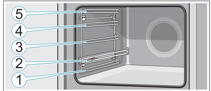
Aux niveaux d'enfournement 1, 3, 4 et 5, introduire l'accessoire toujours entre les deux barres de guidage d'un niveau d'enfournement.
