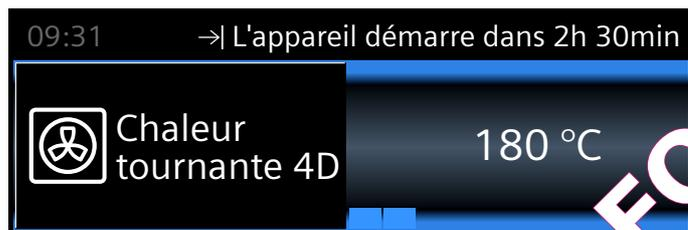
Le four est en position d'attente. Le fonctionnement démarre au moment approprié. La durée s'écoule visiblement dans la ligne d'état.
