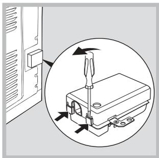
1. Para abrir a caixa de terminais faça alavanca com uma chave de parafuso nas linguetas aos lados da tampa: puxe e abra a tampa (*veja a figura*).
