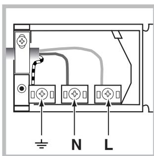
2. Instale o cabo de alimentação: desatarraxe o parafuso do grampo do cabo e os três parafusos dos contactos L-N- $\perp$  e, em seguida, prenda os fios embaixo das cabeças dos parafusos a obedecer as cores: Azul (N) Castanho (L)
