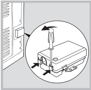
1. Abrir el panel de bornes haciendo palanca con un destornillador sobre las lengüetas laterales de la tapa: tirar y abrir (*ver la figura*).
