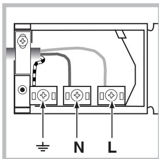
2. Mettere in opera il cavo di alimentazione: svitare la vite del serracavo e le tre viti dei contatti L-N- $\perp$  e poi fissare i cavetti sotto le teste delle viti rispettando i colori Blu (N) Marrone (L) Giallo-Verde  $\perp$  (vedi figura).
