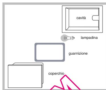
Per sostituire la lampadina di illuminazione del forno:
