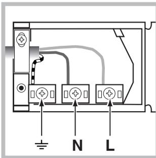
2. Montage du câble d'alimentation : dévisser la vis du serre-câble ainsi que les trois vis des contacts L-N- $\perp$  puis fixer les fils sous les têtes de vis en respectant les couleurs Bleu (N) Marron (L) Jaune-Vert  $\perp$  (voir
