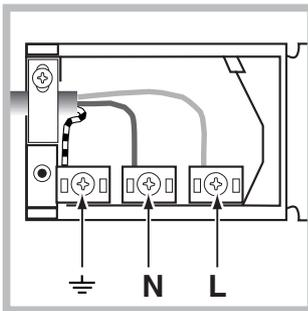
2. Instalar el cable de alimentación eléctrica: aflojar el tornillo de la mordaza de terminal de cable y los tres tornillos de los contactos L-N-
