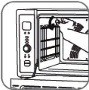
Pour remplacer l'ampoule, débranchez le four et laissez-le refroidir.
