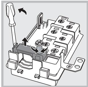
2. Svitare la vite del serracavo e toglierlo facendo leva con un cacciavite (vedi figura).
