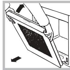
3. segure a porta dos dois lados exteriores e feche-a novamente devagar mas não inteiramente; Em seguida puxe a porta para a frente e retire-a do seu lugar (veja a figura).
