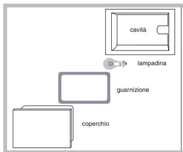
Per sostituire la lampadina di illuminazione del forno:
