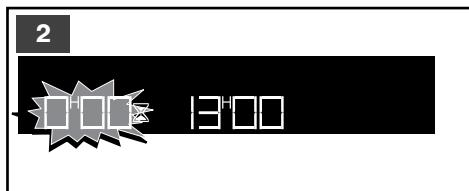
O visor fica fixo após alguns segundos, o temporizador coloca-se em funcionamento e a contagem decrescente de segundo em segundo é iniciada.
