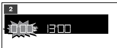
Die Anzeige blinkt nach einigen Sekunden nicht mehr, die Zeitschaltuhr startet und zählt die Zeit sekundenweise rückwärts.
