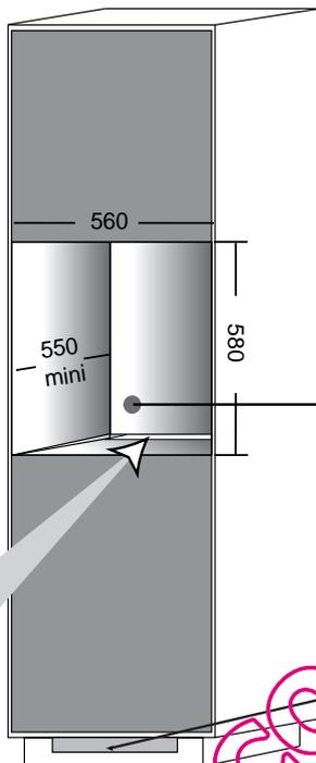
**IT** Se il mobile è equipaggiato con un fondo nella parte posteriore, provvedere a creare una apertura per il passaggio del cavo di alimentazione
