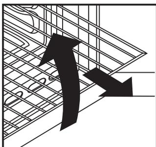
Tous les fours bénéficient d'un nouveau système d'arrêt des grilles. Ce système permet de sortir complètement la grille en totale sécurité. Parfaitement bloquée elle ne peut pas basculer vers l'avant malgré la présence d'un poids important.
