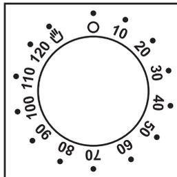
Il est possible de programmer la durée de la cuisson et l'extinction automatique du four (max. 120 minutes). À l'expiration du temps désigné, la manette sera en position O, une sonnerie retentira et le four s'arrêtera automatiquement.
