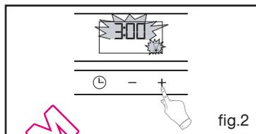
L'afficheur s'arrête de clignoter au bout de quelques secondes, la minuterie se met en marche et décompte le temps de seconde en seconde.
