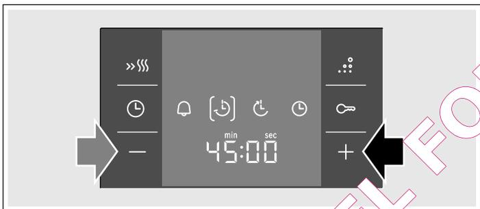
Le four se met en marche quelques secondes plus tard. La durée s'écoule visiblement dans l'affichage et le symbole
