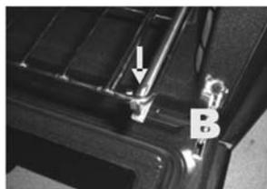
SLIDE OUT THE RUNNERS AND POSITION THE SHELF SUPPORT B BEHIND THE SHELF STOP B LOCATED AT THE FRONT SIDE OF THE KIT.
