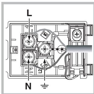
2. Montage du câble d'alimentation : dévisser la vis du serre-câble ainsi que les trois vis des contacts L-N- $\perp$  puis fixer les fils sous les têtes de vis en respectant les couleurs Bleu (N) Marron (L) Jaune-Vert  $\perp$  (voir figure).
