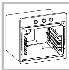
3. Fissare i due telai con le guide montate negli appositi fori posti sulle pareti del forno (*vedi figura*). I fori per il telaio sinistro sono posizionati in alto, mentre i fori per quello destro sono in basso.
