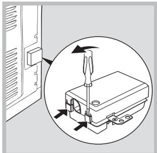
1. Pour ouvrir le bornier, faire pression à l'aide d'un tournevis sur les languettes latérales du couvercle : tirer et ouvrir le couvercle (voir figure).
