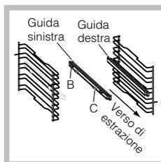
2. Scegliere il ripiano in cui inserire la guida scorrevole. Facendo attenzione al verso di estrazione della guida stessa, posizionare sul telaio prima l'incastro B e poi l'incastro C.
