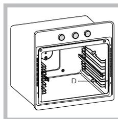
3. Fixer les deux cadres avec glissières assemblées dans les trous prévus sur les parois du four (voir figure). Les trous pour le cadre de gauche sont placés en haut tandis que les trous pour celui de droite sont placés en bas.
