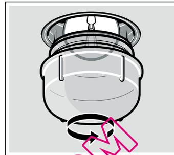
3. Remplacez l'ampoule par un modèle similaire.
