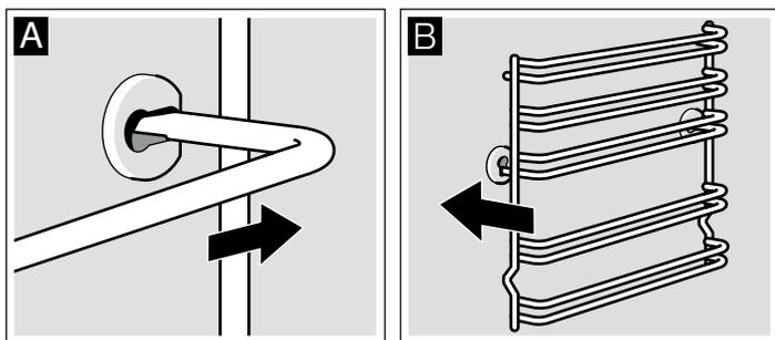
Les clayettes ou les rails peuvent être ajustés à gauche et à droite. La courbure doit toujours être orientée vers le bas.
