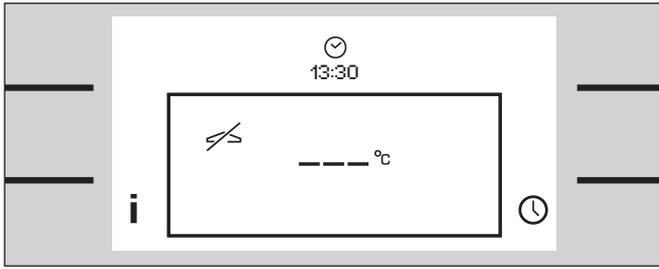
Pour votre protection, l'appareil comporte une fonction de sécurité. Au bout de 12 heures, il est mis fin automatiquement à tout processus de chauffe si pendant ce délai, aucune intervention n'a eu lieu.
