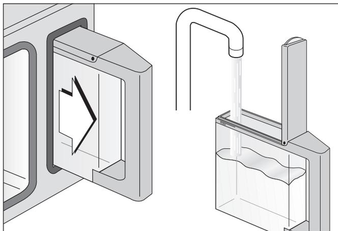
Le réservoir d'eau se trouve sur le côté de l'appareil lorsque vous ouvrez la porte. Selon la version, le réservoir est à droite ou à gauche.
