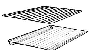
**La grasa** sirve para recoger el jugo de las parrilladas. Sólo se debe utilizar en modo Grill, Asador o Turbogrill (según el modelo). Para los otros modos de cocción, retírela del horno.
