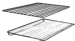
*Dankzij hun speciaal profiel blijven ze steeds horizontaal, zelfs wanneer ze maximaal uitgetrokken zijn. Er bestaat geen enkel risico op het schuiven of overlappen van de gerechten.*
