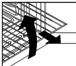
Dit systeem stelt u in staat om de roosters naar voren te trekken zonder het gevaar op te lopen, dat het rooster of het bereide voedsel per ongeluk uit de oven vallen. Om de roosters uit de oven te halen, dient u deze naar voren te trekken en iets op te tillen.
