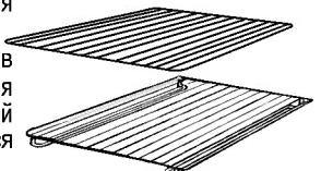
Поддон служит для сбора сока, выделяющегося во время приготовления на гриле. Он используется только при приготовлении на гриле, на вертеле, или на гриле с вентиляцией (в зависимости от модели); при использовании остальных режимов его следует вынимать из духовки.
