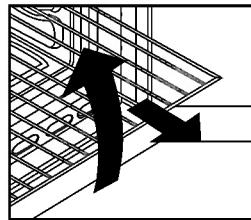
Ihr Backofen ist mit besonders geformten Gleitschienen ausgestattet. Die Gitterroste können fast vollständig aus dem Backofen herausgezogen werden, ohne daß sie nach unten klappen.
