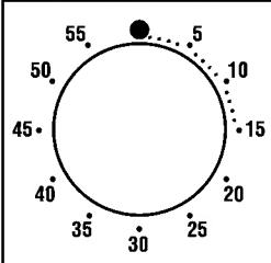
Pour sélectionner le temps de cuisson tournez le bouton sur le temps désiré. Dès que le temps de cuisson est écoulé une sonnerie retentit. Il ne vous reste plus qu'à couper manuellement le four.
