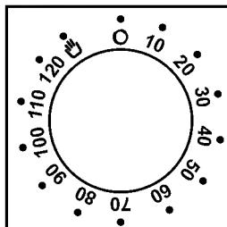
Con este mecanismo es posible programar la duración exacta en minutos de la cocción y, por tanto, la desconexión automática del horno (máx.120 minutos). Una vez transcurrido el tiempo seleccionado el mando alcanzará la posición de señal acústica O, a partir de la cual el horno se desconectará automáticamente.
