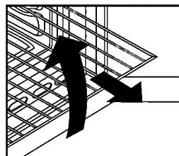
Il forno è dotato di un nuovo sistema di arresto griglie. Questo sistema consente di estrarre le griglie quasi completamente senza che queste fuoriescano dal forno mantenendole perfettamente in piano, consentendo di verificare e mescolare il cibo con la massima tranquillità e sicurezza.
